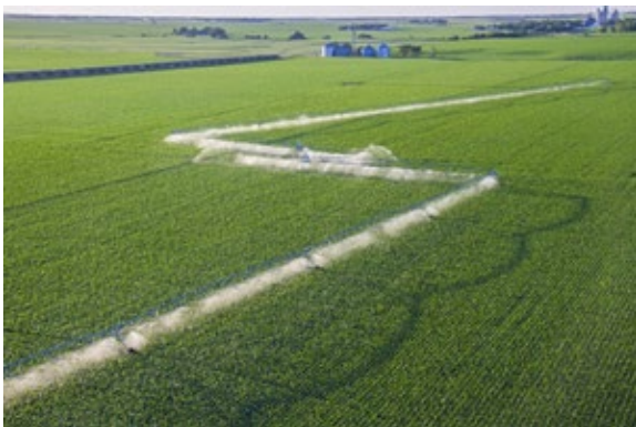
Obr. 31 Moderní pivotové zavlažovací stroje a podkladní vrstvy pro precizní zavlažování. Zdroj: https://valmont.showpad.com
