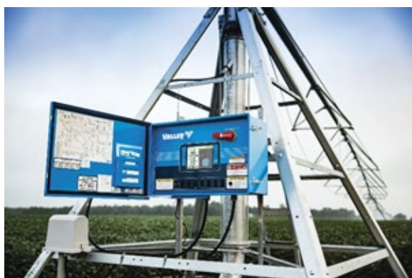
Obr. 32 Ovládací panel (na pivotu) lze u pivotového zavlažovacího stroje pomocí aplikace nastavit i na svém zařízení. Zdroj: https://valmont.showpad.com
