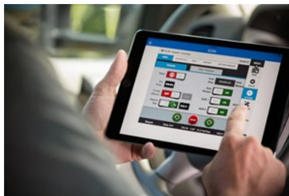
Obr. 32 Ovládací panel (na pivotu) lze u pivotového zavlažovacího stroje pomocí aplikace nastavit i na svém zařízení. Zdroj: https://valmont.showpad.com
